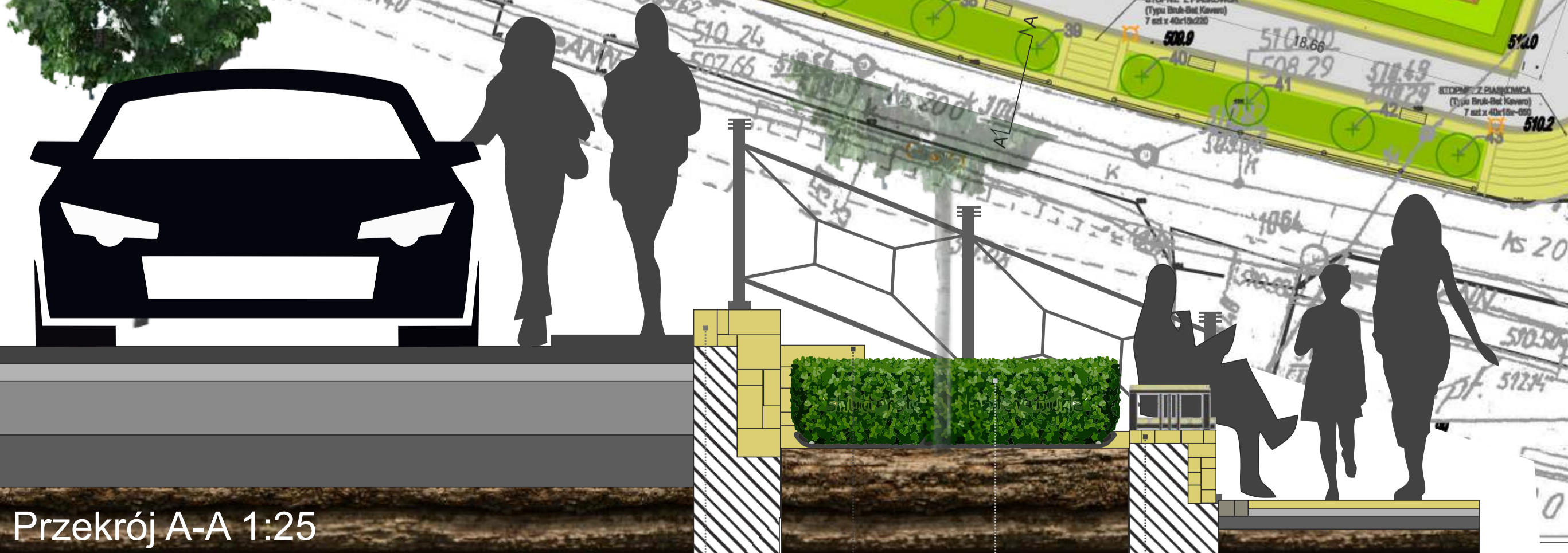
Linia oporowa h 120 cm z piankocementu z balustradą | schody typu Kavero Bruk-Bet z balustradą | zwyplot z bukszpanu | linia oporowa h 40 cm z siaroziskierii adaptacja ławki Szczepańskiej ZANO
