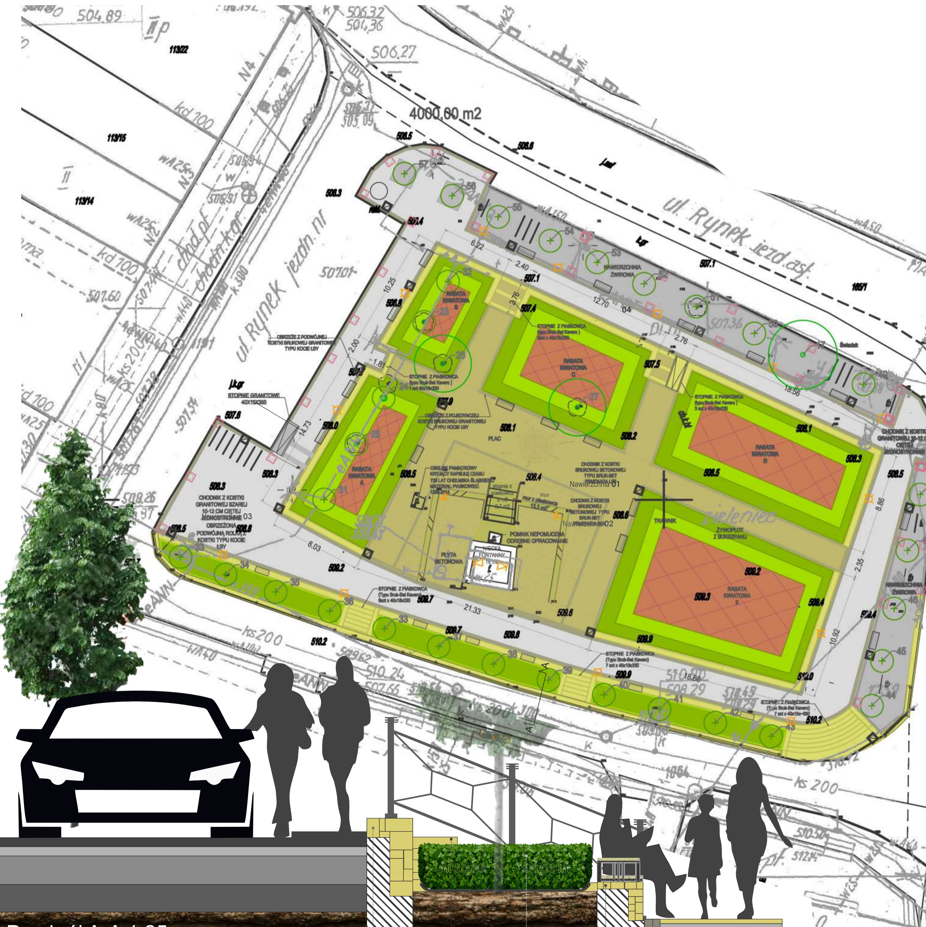
Linia oporowa h 120 cm z piankocementu z balustradą | schody typu Kavero Bruk-Bet z balustradą | zwyplot z bukszpanu | linia oporowa h 40 cm z siaroziskierii adaptacja ławki Szczepańskiej ZANO
